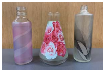
写真1 ガラス瓶への円周印刷
