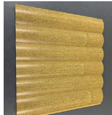
写真4 プラスチック成形品の竹模様
